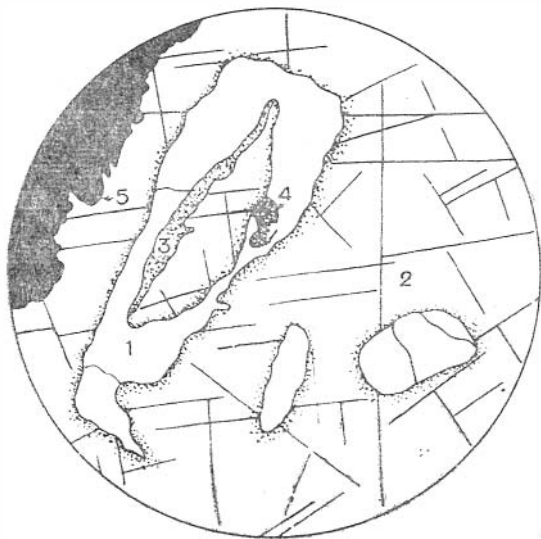
Рис. 38. Реликтовые зерна пирита (1) среди галенита (2); 3 — халькопирит; 4 — сфалерит и 5 — нерудный. Полированный шлиф. Увел. 25. Тургеневское месторождение.
