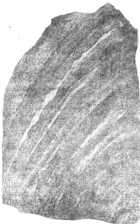
Рис. 39. Полосчатая текстура магнетитовой руды. Фото штуфа керна. Натуральная величина. Кочуринское месторождение.
