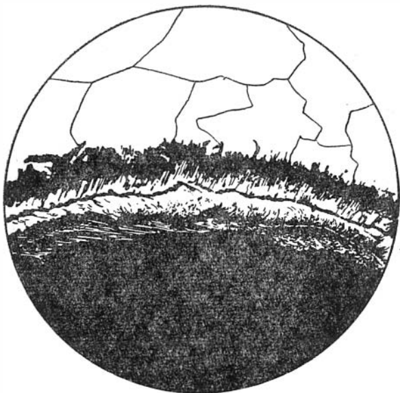
Рис. 6. Деталь кремнистого прослоя в молибденитовом сферолите. Черное — молибденит, в центре — кварцин тонковолокнистого строения, вверху — зернистый жильный кварц. Прозрачный шиф. Николи скрещены. Увел. 38.
