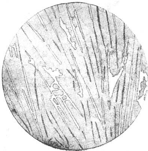
Рис. 48. Выделения пластинок мушкетовита (серое) в ассоциации с пиритом (светлое). Черное — нерудный. Зарисовка полированного шлифа. Увел. 35. Шалымское месторождение.
