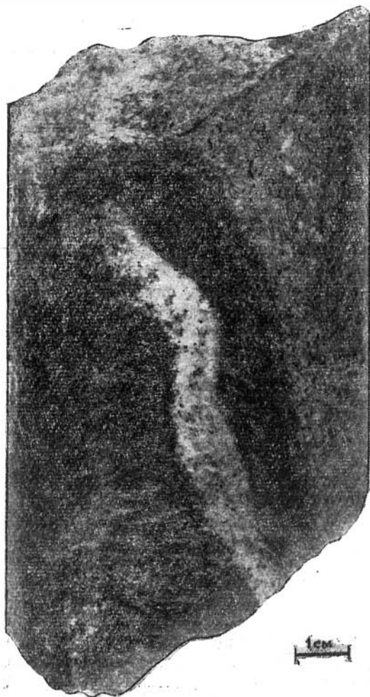
Рис. 57. Штуф ядра массивного гранита с включением ксенолита магнетитовой руды. В магнетите наблюдается инъекция гранитного материала (светлый прожилок в центре фотографии).
