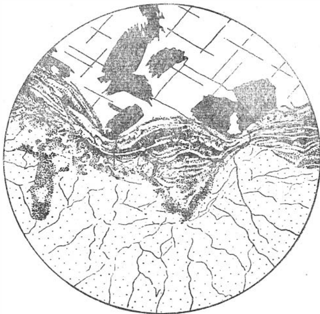
Рис. 21. Концентрически-зональное строение граната. Черные пластинчатые выделения — гематит. Прозрачный шлиф. Николи параллельны. Увел. 30. Шалымское месторождение.
