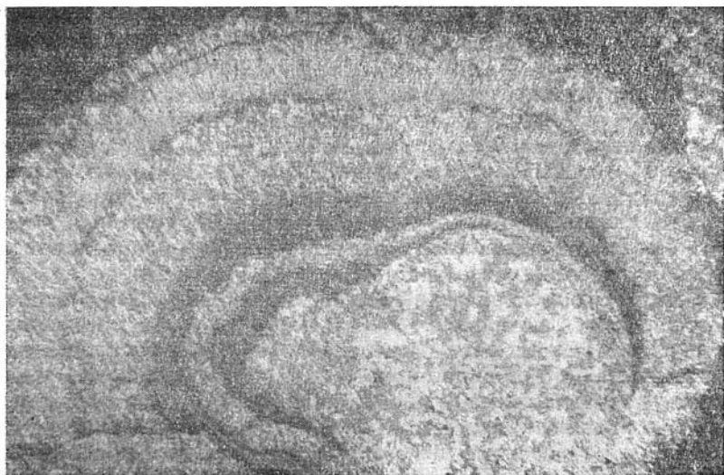
Рис. 4. Почковидное образование молибденита (светлое) с чередованием зон различной зернистости. Черное — кварц. Полированный шлиф. Увел. 80. Шалымское месторождение.
