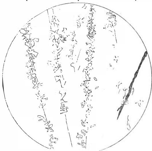
Рис. 12. Полосовидное распределение фигур травления в магнетите (вдоль- тончайших трещинок). Черное — кальцитовый прожилок. Полированный шлиф. Увел. 400. Шерегешевское месторождение.
