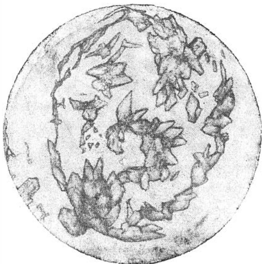
Рис. 25. Кучное скопление титанита в околоскарновой диопсид-плагиоклазовой породе Шалыма. Прозрачный шлиф. Увел. 120.
