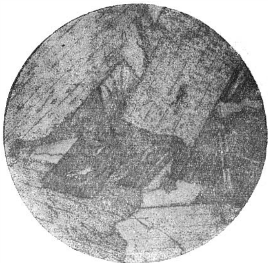
Рис. 24. Выделение титанита (кристалл в центре) в ассоциации с кварцем и эпидотом. Вмещающая порода — сиенит. Прозрачный шлиф. Увел. 30.
