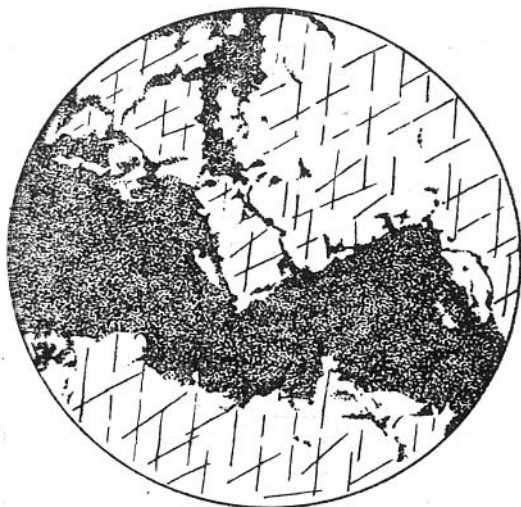
Рис. 60. Замещение мраморизованного известняка (светлое) пиритом. Уменьшено в 1 1/2 раза. Кочуринское месторождение.
