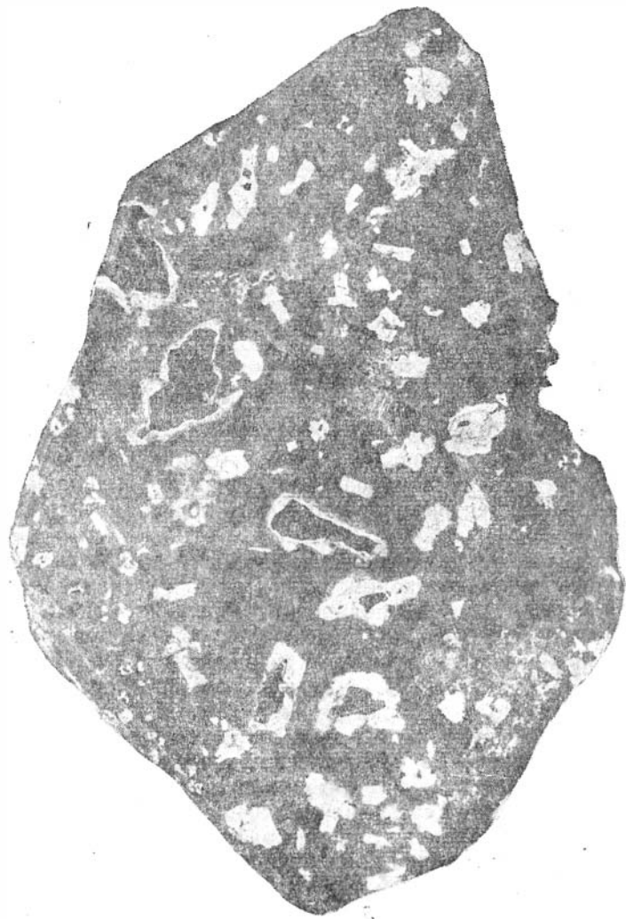
Рис. 19. Полированная поверхность штуфа гранатового скарна с концентрически-зональным гранатом (светлое), облекающим пустоты (темное). Натуральная величина. Шалымское месторождение.
